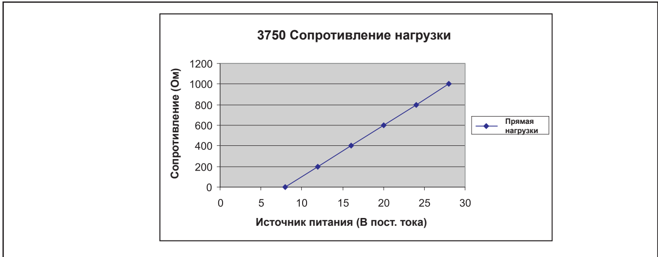
Рисунок 1-2 Источник питания и максимальное сопротивление нагрузки
