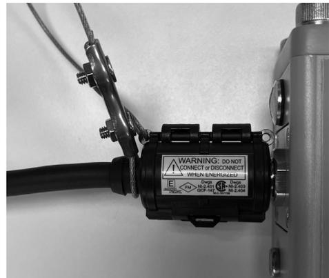
次に、ストレートワッシャーをケーブルと両方のボルトにかぶせ、付属のナット2個で固定します。ナットは7mmです。
